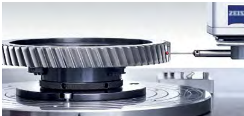
Contrôle de la qualité de denture sur une machine de mesure 3D
